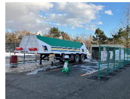
水素トレーラー
